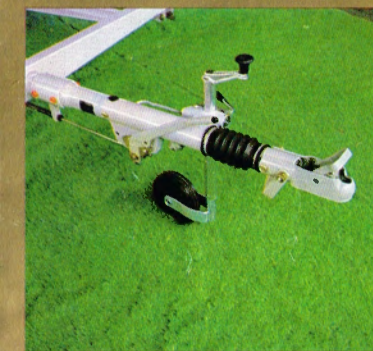
Geliefert wird mit Auflaufbremse, Handbremse und ein Deichselrad.
