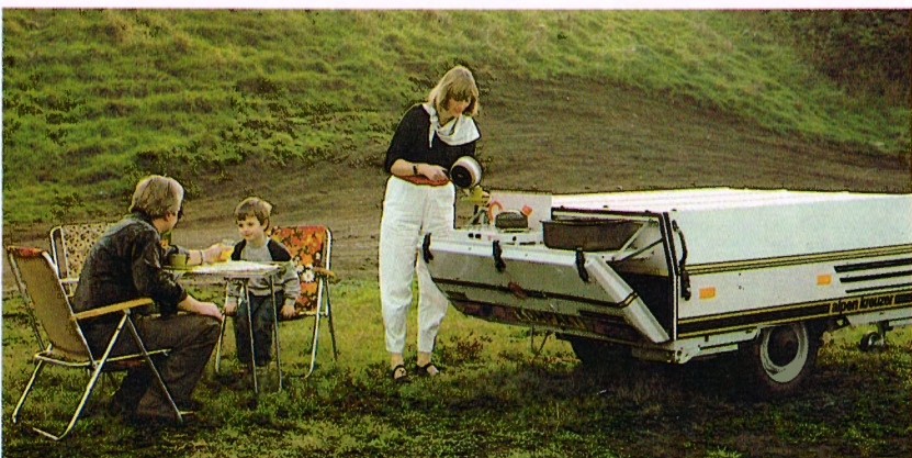
Der Alpen Kreuzer KOMPAKT EXPORT hat eine eingebaute ausklappbare Einbauküche mit Zweiflamm-Gaskocher und Waschbecken, die unterwegs ganz einfach aus dem hinteren Gepäckraum hochgeklappt werden kann.
