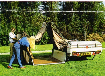
2. Wagenzelt mit EINEM Griff einschl. Gestänge nach links hochziehen ...
