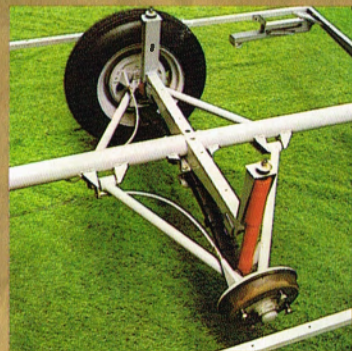
Das unabhängige Federsystem ist mit Stossdämpfern ausgerüstet. (Super GT)
