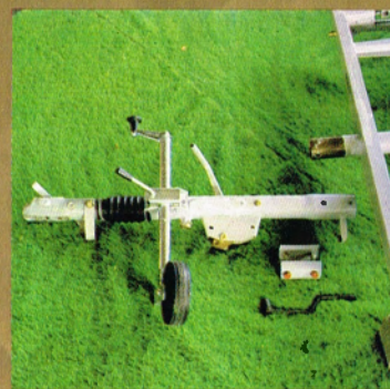
Abnehmbare Deichsel für problemlose Lagerung.
