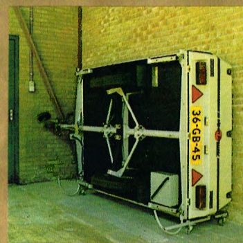
Das robuste Fahrgestell kann vom Wagen abmontiert werden. Wenn erwünscht, kann eine Reserveradhalterung + ein Reserverad mitgeliefert werden.
